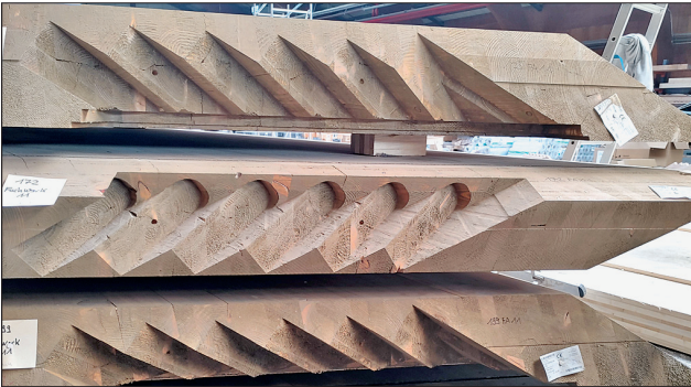
Ausfräsungen für die Steckverbindung an Fassadenbauteilen
